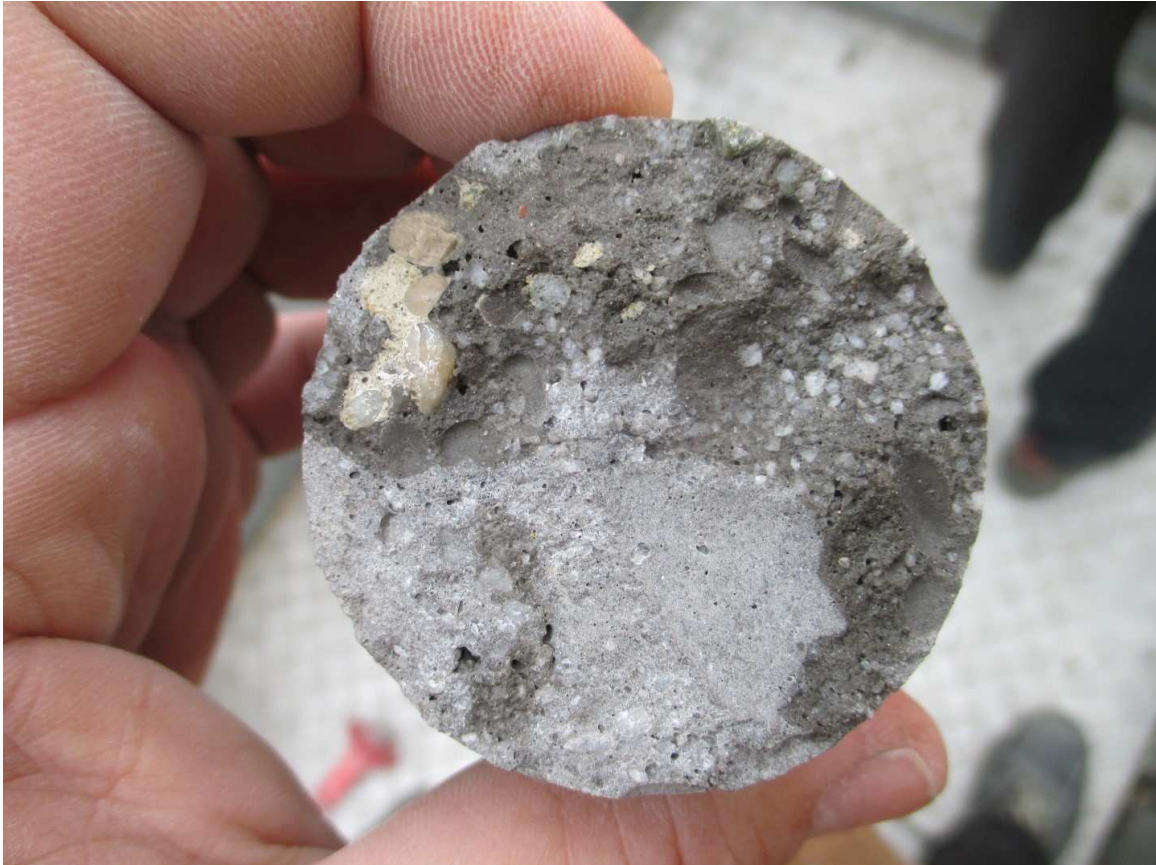
Bild 9: Ansicht Unterseite Bk2 mit Riss (mittig horizontal durchs Foto), Abbruch in Verbundfuge von Beschichtung / Altbeton
