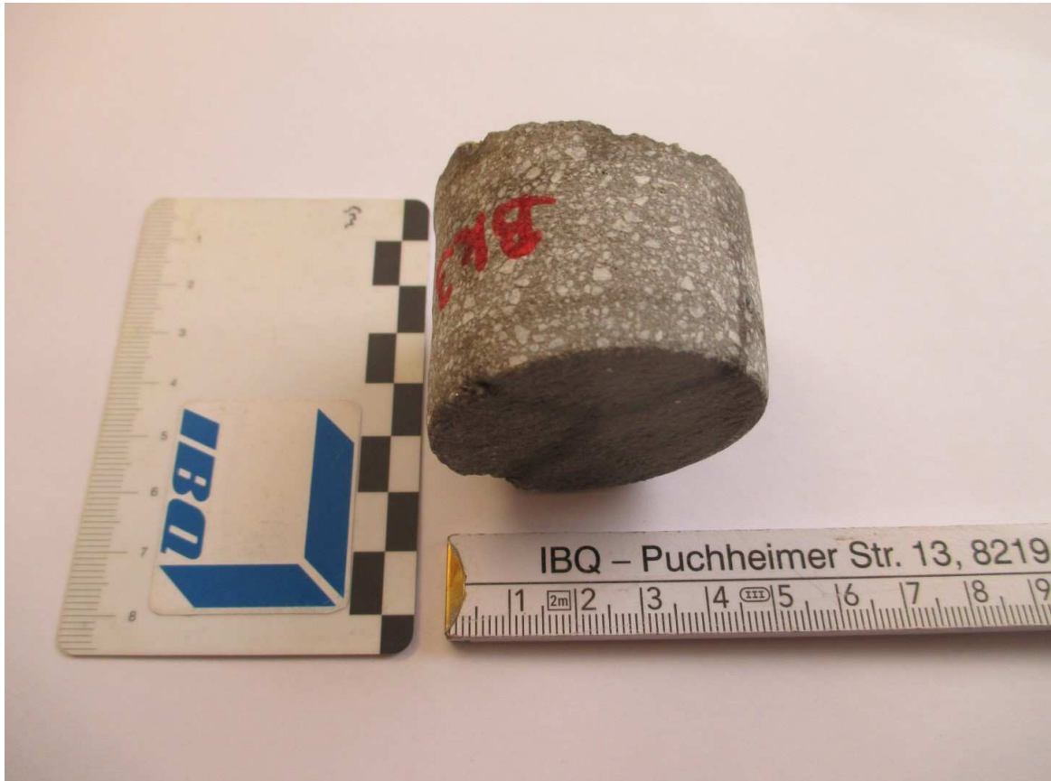
Bild 13: Ansicht Bohrkern Bk3 mit dreistrahligen Riss an der Oberfläche, Abbruch in Verbundfuge Beschichtung / Altbeton
