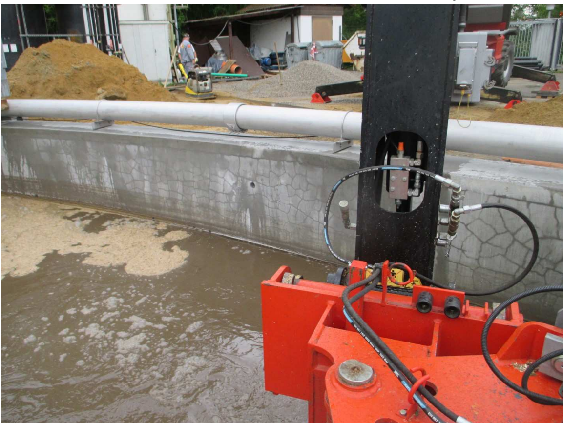
Bild 16: Ansicht Lage des Bohrkerns Bk2 aus Kanzel des Teleskopladers und allgemeines Rissbild
