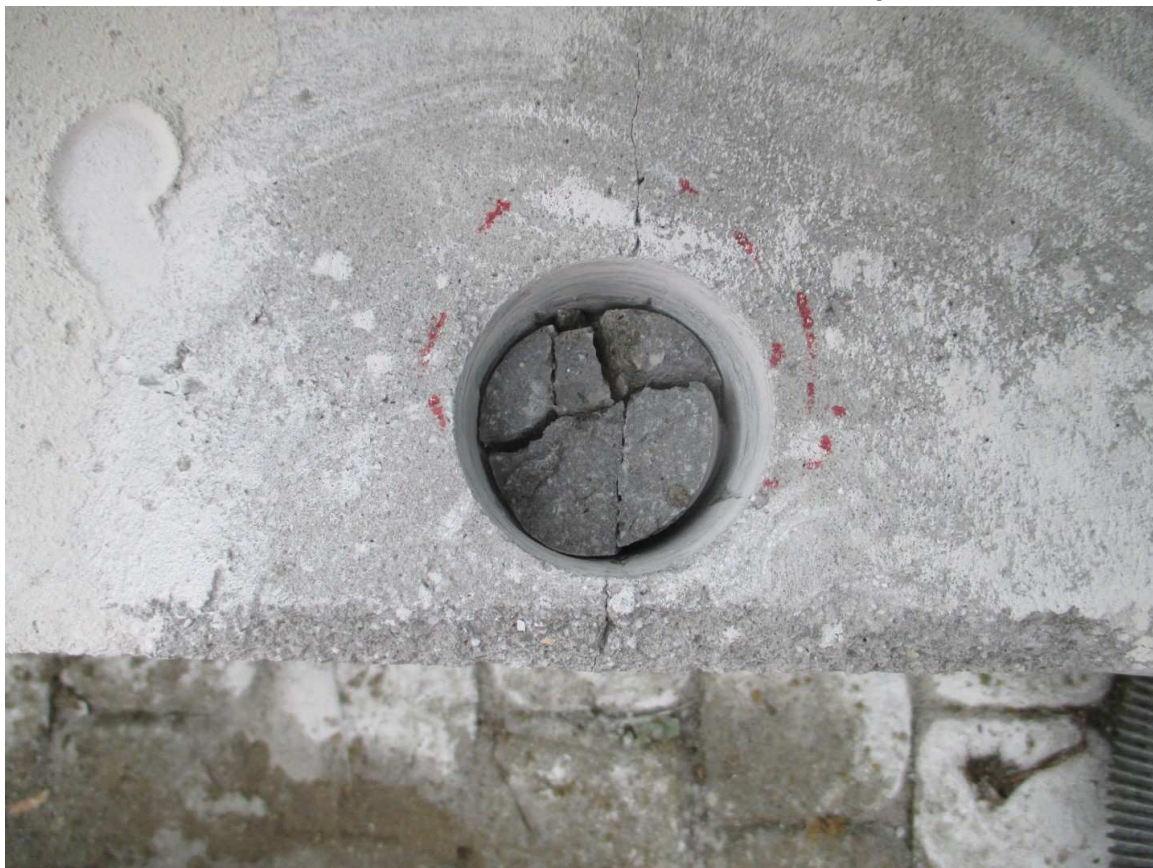
Bild 4: bei Entnahme zerfallener unterer Teil = 1. Lage des Bohrkerns Bk1
