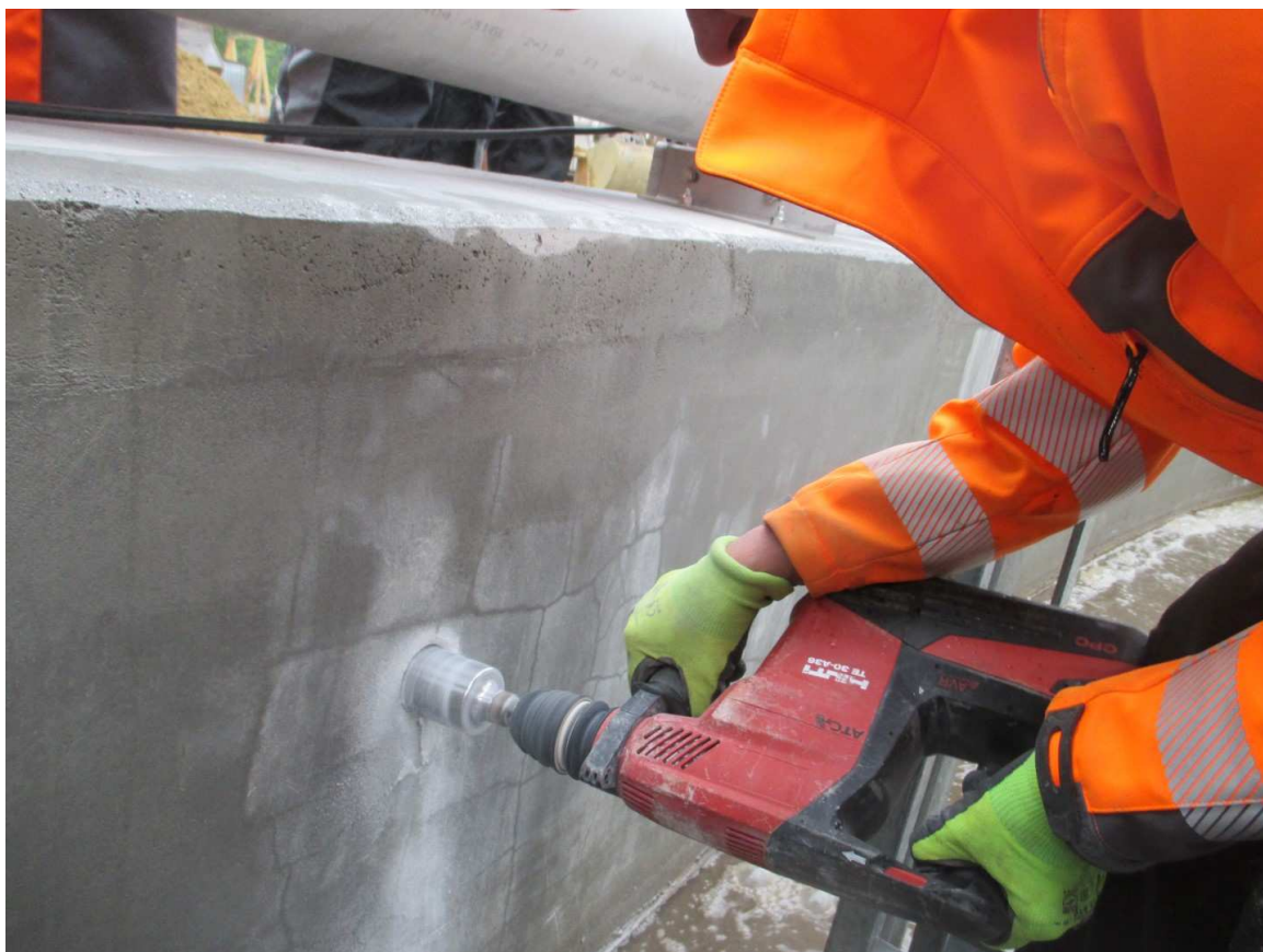
Bild 5: Ansicht des Rissbildes sowie Entnahme des Bk2 im vertikal verlaufenden Netzriss mit Akkubohrmaschine
