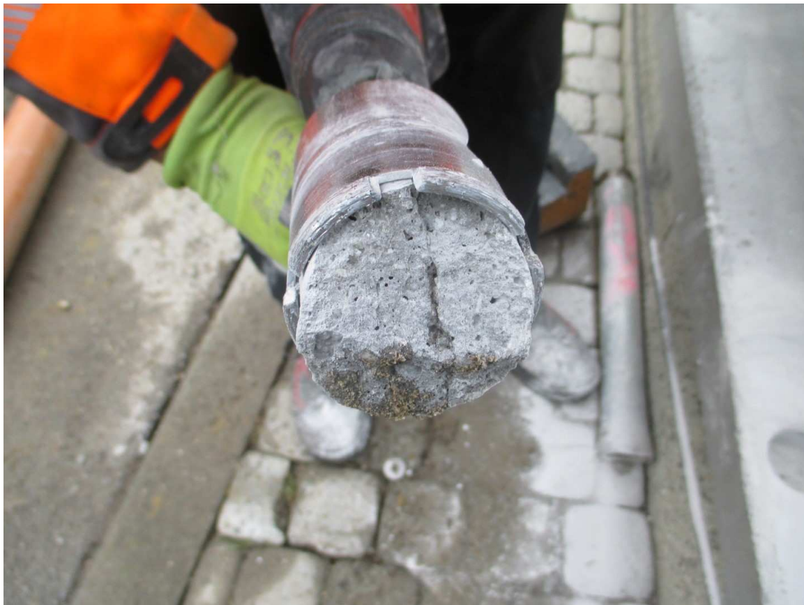
Bild 3: Ansicht des feuchten Risses an der Unterseite der oberen 2. Lage der Beschichtung beim Bk1, Abriss beginnend in Verbundfuge
