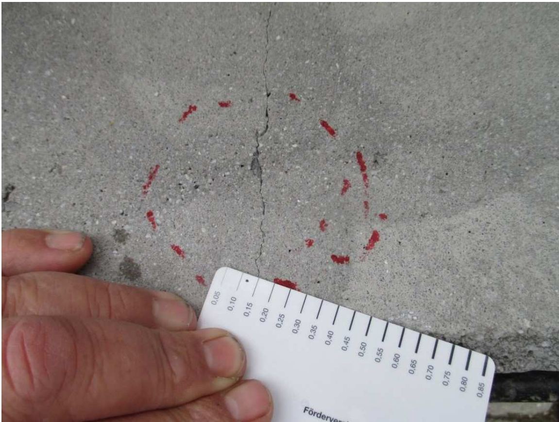
Bild 1: Ansicht Untersuchungsstelle Bk1 auf der Wandkrone, Rissbreite 0,15 mm
